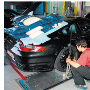
Auflastung: Die Freigängigkeit der Räder muss gegeben sein.
