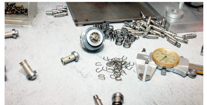
Puzzle: Die Stossdämpfer werden von Hand zusammengesetzt.
