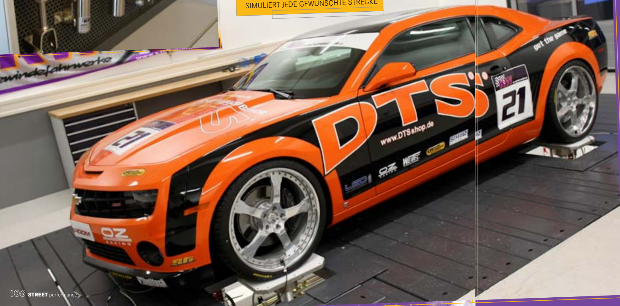
DER FAHRDYNAMIKPRÜFSTAND SIMULIERT JEDE GEWÜNSCHTE STRECKE
