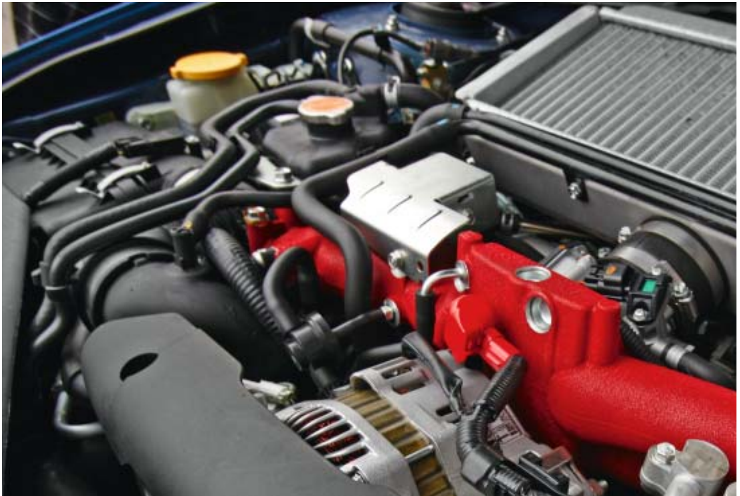
FETTE BOXER-POWER Mit optimiertem Intercooler und doppelt variabler Ventilsteuerung leistet die Serie 300 PS, die Delta-Version 340 PS (Bild).
